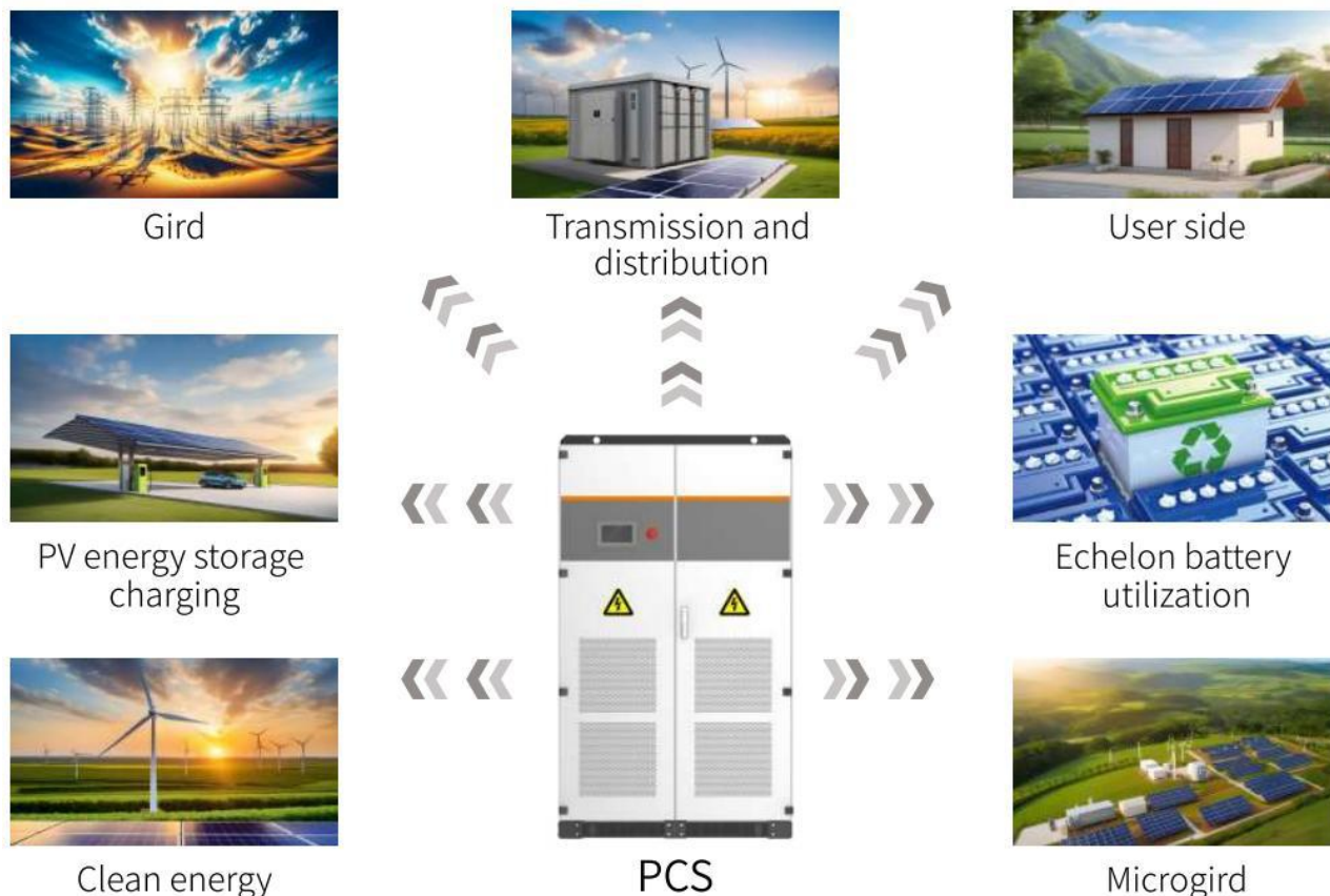
图 3.8.2-1 混合逆变器在 ESS 中的应用场景
